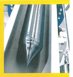
Links: Verfahrenschritte der Kristallisation: Einschmelzen des Siliziumgranulats, Ziehen des Dünnhalses und der Schulter, Längenwachstum.
