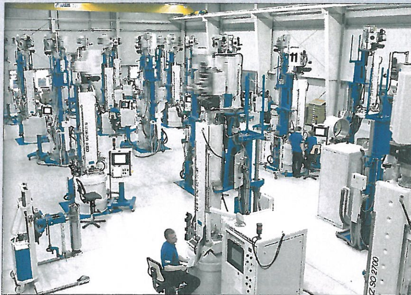
4: Blick in eine Produktionshalle mit Einkristallzuchtanlagen: Die Antriebs- und Automatisierungstechnik ist so konzipiert, dass sich die Kristallisation optimal beherrschen lässt.
